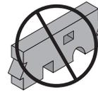
*No corte, ranure, ni barrene en cabezales o vigas excepto como se indica en las ilustraciones y en las tablas.*
